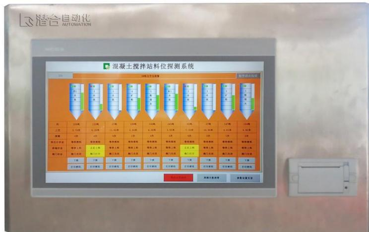
磅房触摸屏配置嵌入式打印机，每次上料均打印上料密码，密码为动态密码，每次上料自动随机生成，密码由四位数字组成，前两位为仓号，后两位为随机密码，“双保险”确保系统安全。
